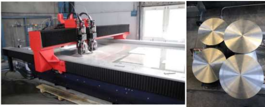
A gauche : Découpe au jet d'eau des ébauches, à droite : panneaux de construction finis
